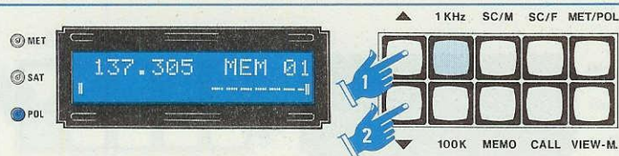
Fig.51 Per modificare una frequenza di pochi Kiloherz sarà sufficiente pigiare i tasti P1 oppure P2.
